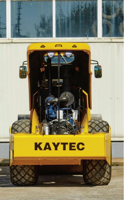
диатора охлаждения двигателя и впускной воздушной системы двигателя способствует эффективному охлаждению даже в тяжёлых условиях эксплуатации, снижая вероятность перегрева и продлевая срок службы двигателя и гидравлики.
