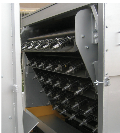
Полунаклонный грохот SIGMA сочетает производительность наклонных моделей и точность горизонтальных
