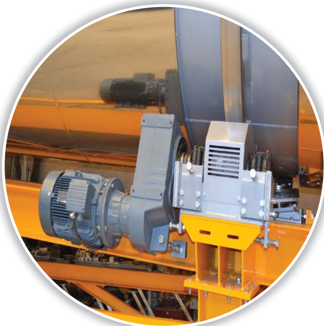
Опорные ролики с регулировкой по двум осям Drive rollers adjustable in two axes
