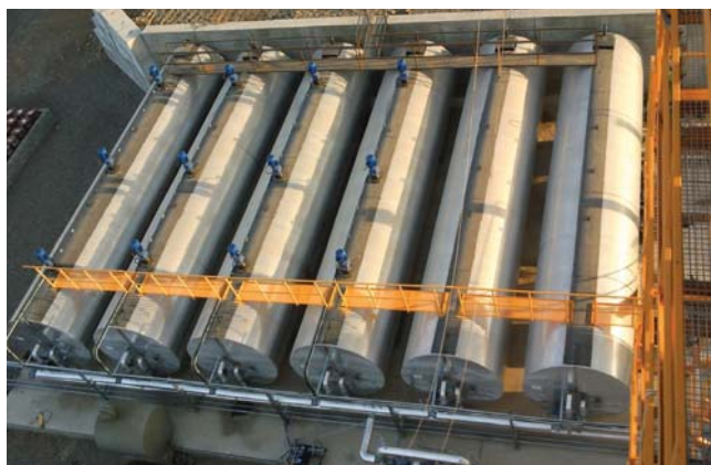
Горизонтальные битумные емкости с термомасляным обогревом Horizontal bitumen tanks, thermal oil heated
