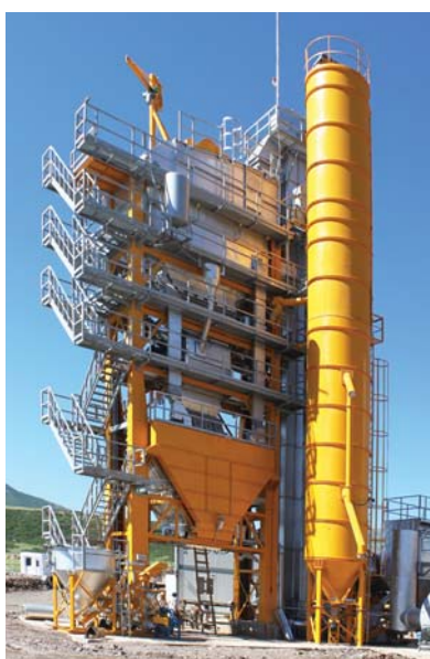
Силос минпорошка и пыли башенного типа Tower type filler silo
